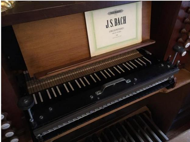
Der Manualaufsatz für das ecantore-System ist auf allen Pfeifenorgeln einsetzbar und kann reversibel an Ihre Orgel angepasst werden ohne in die Mechanik der Orgel einzugreifen. So können Sie auf sehr einfache Weise ihre Orgel für das ecantore-System vorbereiten.
